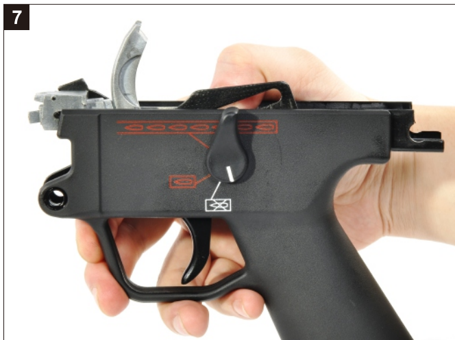
將保險抓桿下壓。 Press down the Catch Lever.
