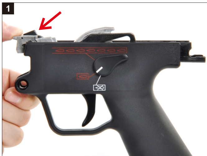
下壓箭頭處鐵片之擊錘撥桿。 Depress the Release Lever.
