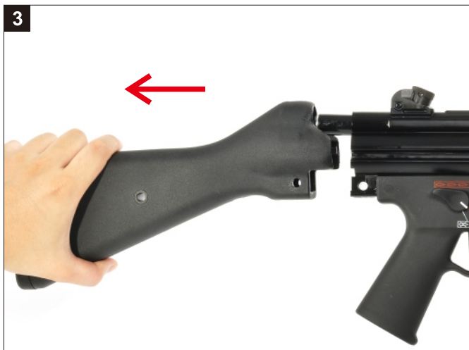
移除槍托。 Remove the Buttstock.
