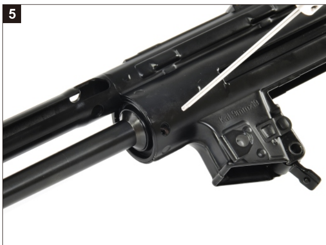
移除槍管兩側固定螺絲。 Remove the Barrel Screw.
