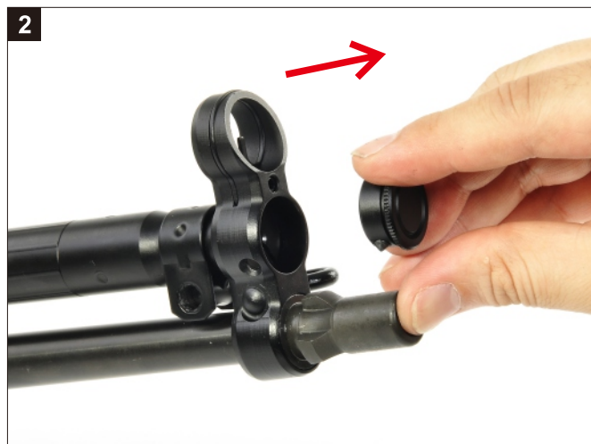
移除拉柄套筒前蓋。 Remove the Cap of the Cocking Tube.
