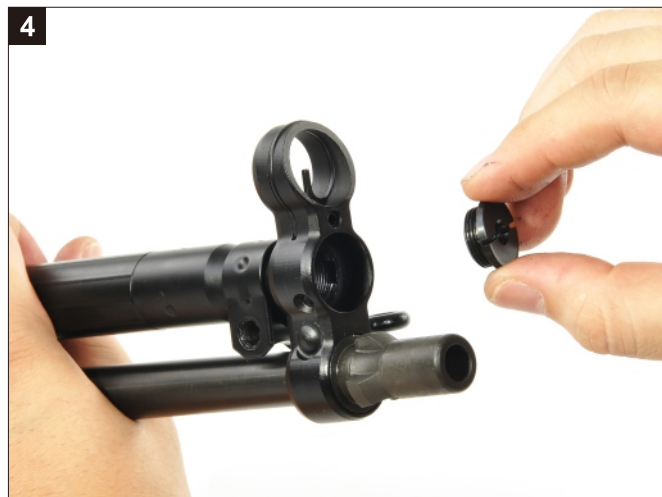
移除拉柄套筒螺帽。 Remove the screw of Cocking Tube.
