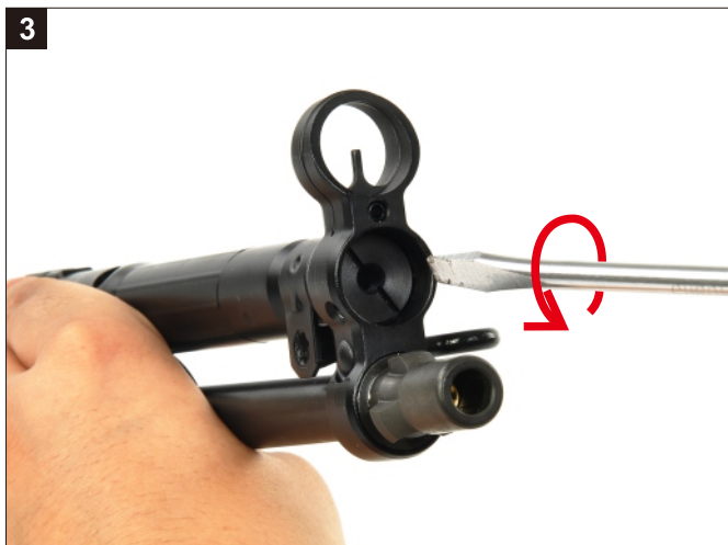
以工具將拉柄套筒螺帽逆時針方向旋出。 Anticlockwise the screw of Cocking Tube.
