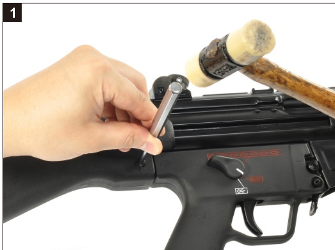
移除槍托插梢。 Remove the Rear Pin.
