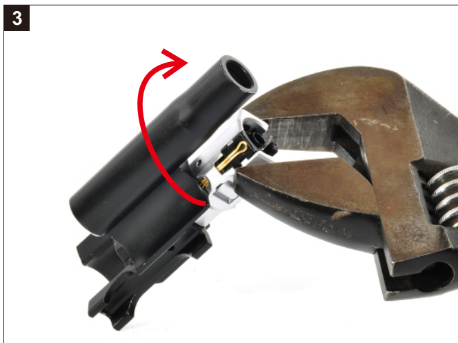
以工具將槍機頭外罩作順時針方向旋轉。 Clockwise the Bolt Head.
