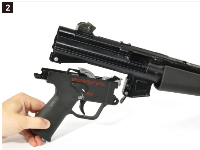
卸下扳機組。 Remove the Trigger Group.
