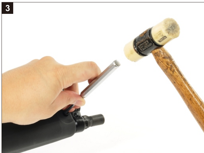
移除護木插梢。 Remove the Forearm Locking Pin.
