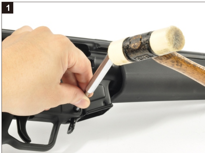
承前頁，移除槍身插梢。 Remove the Trigger Group Locking Pin.
