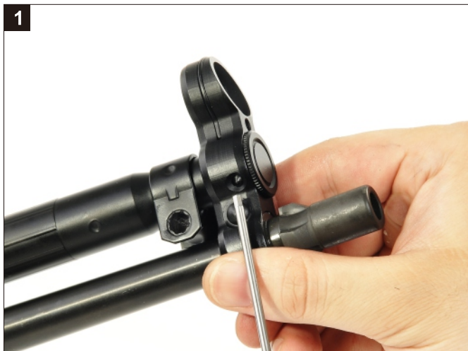
以工具將拉柄套筒前蓋頂出。 Depress the pin.
