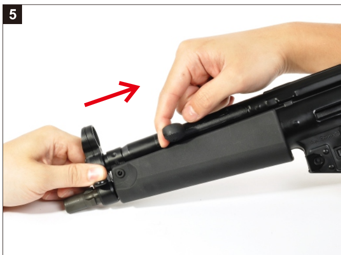
拉動槍機拉柄，使槍機組向後退出。 Pull the Cocking Lever rearward.
